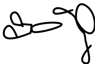
Slangklämma (2) (för att sätta fast dräneringsslangkoppling)
