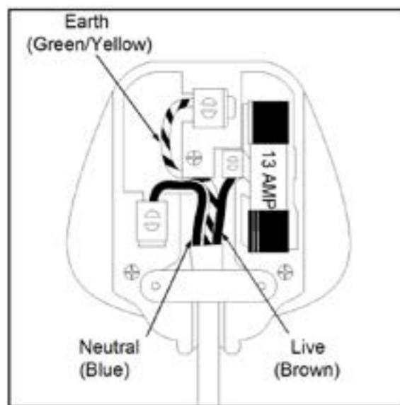
Dieses Gerät ist mit einem Stecker mit einer 13-A-Sicherung ausgestattet. Wenn diese herauspringt, ist sie gegen eine ASTA-genehmigte Sicherung (gemäß BS1362) mit demselben Amperewert auszutauschen.
