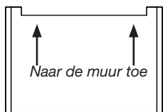
Achterste ventilatie van boven gezien
