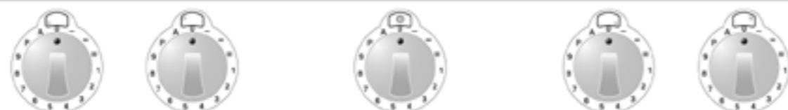
Befinden sich beim ersten Einschalten des Kochfelds ein oder mehrere Drehknöpfe nicht in der Position „0“, leuchten die entsprechenden Anzeigen zwar wie gewohnt, **das Heizelement funktioniert jedoch nicht**.
