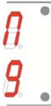
**Drehen Sie die letzten beiden rechten Drehregler gleichzeitig im Uhrzeigersinn** (über die Leistungsstufe „9“ hinaus, bis ein Klicken und ein akustisches Signal zu hören ist) in die Position „P“ und halten Sie sie für mindestens **2 Sekunden** in dieser Position (die entsprechenden Anzeigen zeigen die nebenstehenden Symbole an und signalisieren damit, dass die Funktion aktiv ist). Drehen Sie den zweiten Knopf nach rechts auf die gewünschte Leistungsstufe.
