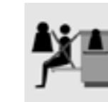
SICH AUF EINE OFFENE OFENTÜR, EINE SCHUBLADE ODER EIN AUFBEWAHRUNGSFACH ZU SETZEN ODER SICH DAGEGEN ZU LEHNEN, KANN ZUM KIPPEN DES GERÄTS FÜHREN UND SCHÄDEN VERURSACHEN. DIE SCHUBLÄDEN HABEN EINE DYNAMISCHE TRAGFÄHIGKEIT VON 25 KG.
