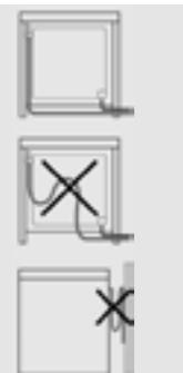
Bei Verwendung von flexiblen Gummischläuchen mit einer maximalen Länge von 1500 mm:
